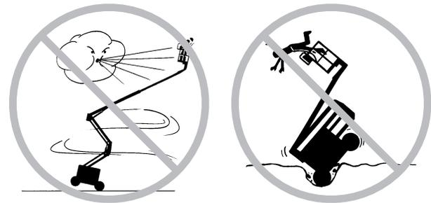
Cuando conduzca la máquina en posición plegada a través de terrenos irregulares, escombros, superficies inestables o resbaladizas, o cerca de socavones y pendientes, extreme las medidas de precaución y conduzca a velocidad reducida.
