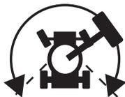
Para desplazarse, mantenga presionado el conmutador de activación de desplazamiento en cualquier sentido y aleje del centro lentamente la palanca de control.
